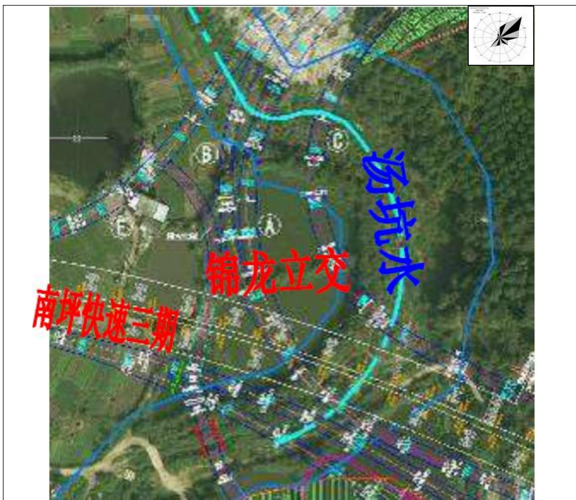
锦龙立交 段（桥梁上跨汤坑水，河中设桥桩）
