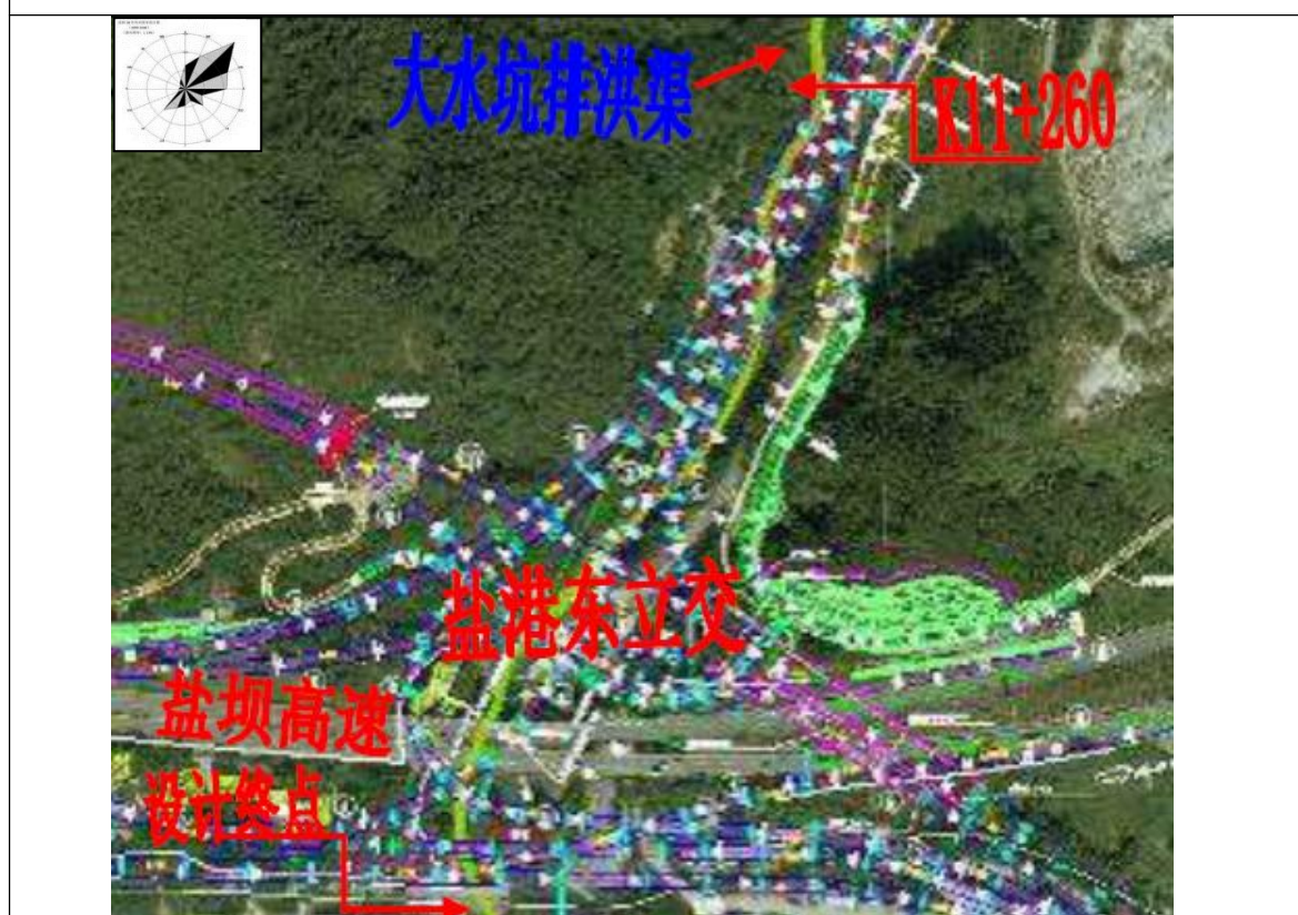
以高架形式上跨大水坑排洪渠，河中设桥桩
