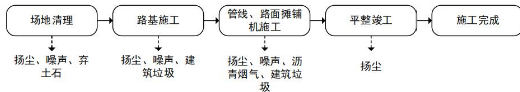
图 2-20 道路施工工艺及产污环节图
